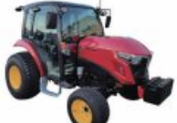
중형트랙터 YT-357T (57HP/HMT 무단변속/전방PTO)
