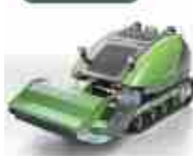
ROBOFOX HYBRID 28마력 가솔린, 50도 등판, 무선거리 300m
