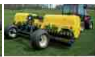
AERWAY90 무동력 에어레이터 작업심도 최대 170mm 옵션 : 더블데크
