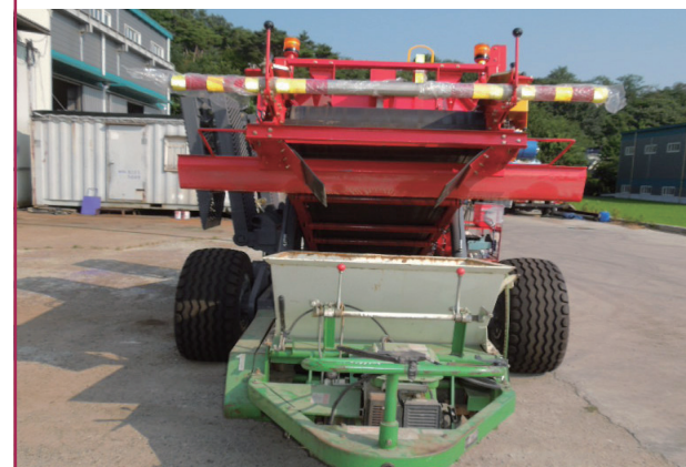
그린 배토기에 배토사 공급 / 정밀 공급용 가이드 설치
