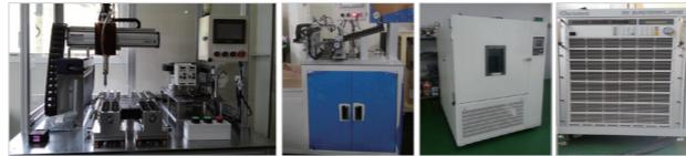
배터리 모듈 자동 조립 로봇   셀 자동 커팅 머신   항온항습기   부하시험기
